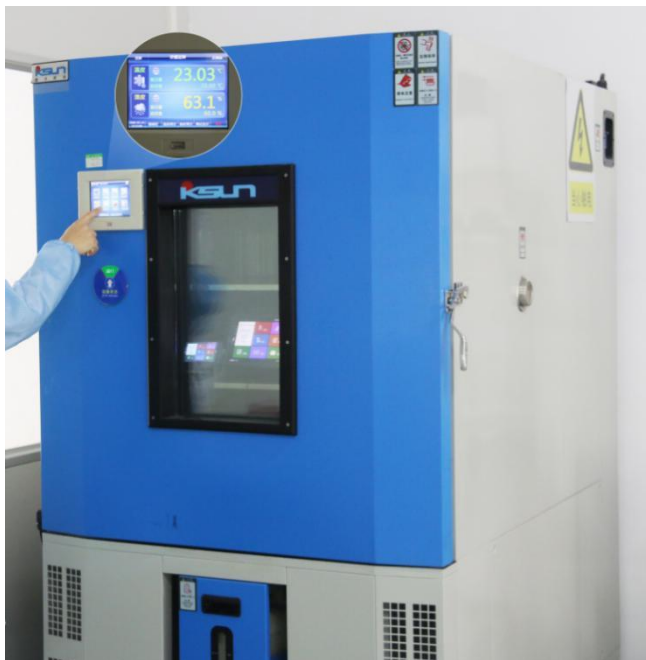
图 5-3 高低温老化测试图
